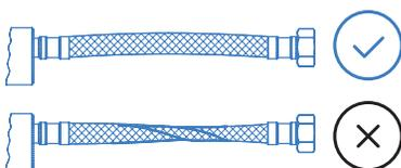
**No instalar la conexión con la parte flexible en torsión.**
