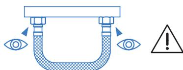
**Se recomienda verificar la instalación para detectar posibles fugas una vez finalizado su montaje.**
